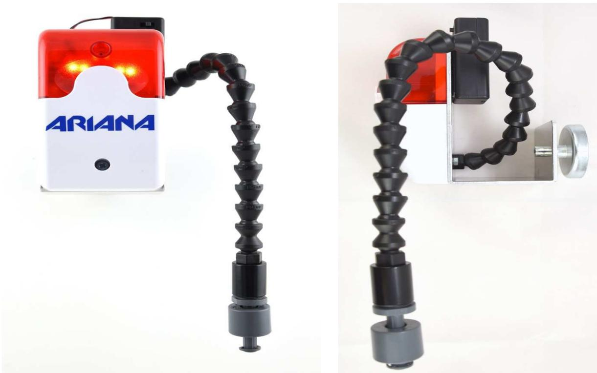
**ARIANA-Überlaufschutz-Sirene** ist ein wichtiges Instrument für jede Bearbeitungsmaschine, die mit Emulsion oder mit Öl befüllt wird. Die Überlaufschutz-Sirene meldet akustisch und per Lichtsignal ein bevorstehendes Überlaufen. Durch Einstellung des beweglichen Gelenkschlauchs kann man das Niveau im Becken bestimmen. Ein Überlaufen wird durch die akustische Warnsirene signalisiert.
